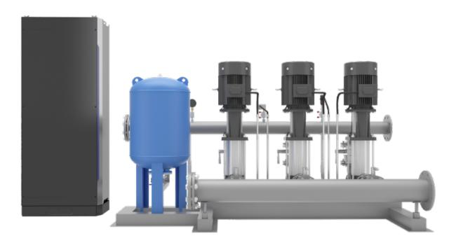
变频恒压供水设备是水处理设备中的一种,变频水箱是一种新型的节能供水设备。变频恒压供水设备系运用当今先进的微电脑控制技术,将变频调速器与电机水泵组合而成的机电一体化高科技节能供水装置。变频恒压供水设备以水泵出水端水压(或用户用水流量)为设定参数,通过微机自动控制变频器的输出频率从而调节水泵电机的转速,实现用户管网水压的闭环调节,使供水系统自动恒压稳于设定的压力值:即用水量增加时,频率提高,水泵转速加快;用水量减少时,频率降低,水泵转速减慢。不需建造水塔,投资小、占地少,采用水气自动调节、自动运转、节能与自来水自动并网,停电后仍可供水,调试后数年不需看管。比建造水塔节约投资70%,比建造高位水箱节约投资60%,节约土建投资。水箱 无负压供水 变频供水 真诚推荐 品质有保障。北京水箱制造商
